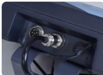
Connexion indicateur plate-forme et alimentation électrique. Support mural ou au sol
