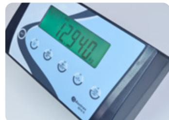
Indicateur LCD en ABS avec batterie interne d'une durée de 100h sans interruption
